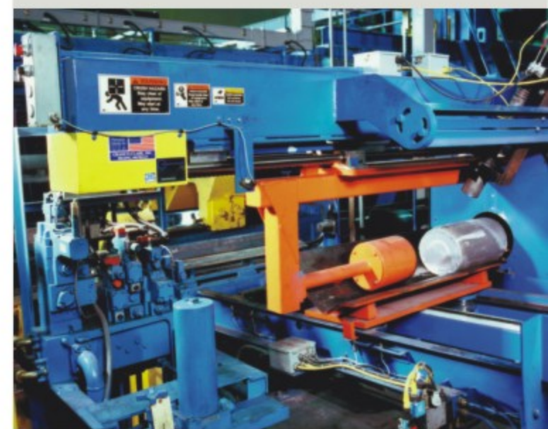
格兰克 (GRANCO CLARK) 独特的多项专利权的梯度水冷装置是生成等温挤压所需的温度梯度的最经济的方法。梯度水冷装置也能处理柱棒快速固熔工艺。
