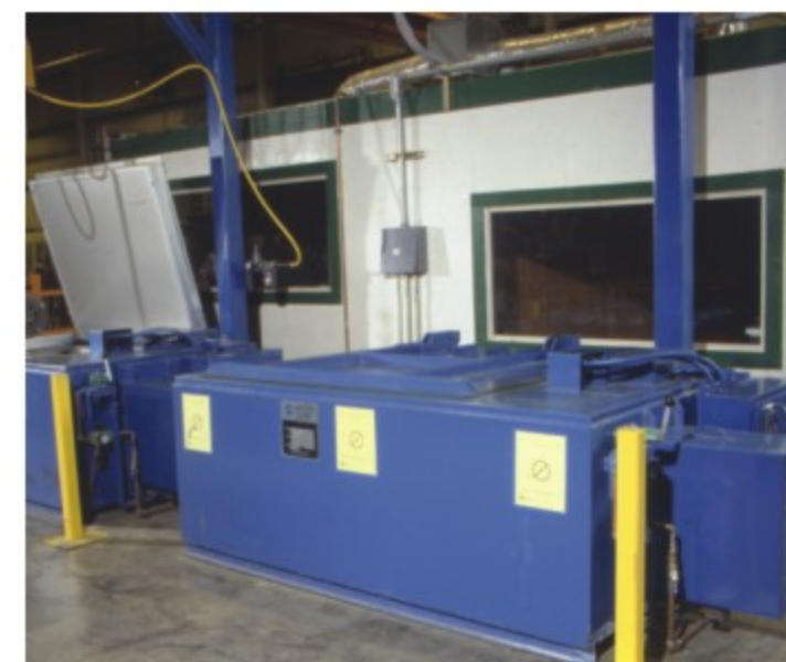
格兰克 (GRANCO CLARK) 腔式模具炉结构坚固，是模具加热的经济选择。
