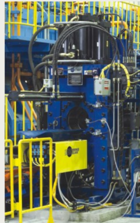
由于格兰克 (GRANCO CLARK) 热剪能按 需剪切正确长度的柱棒，所以能减少库存 和废料。
