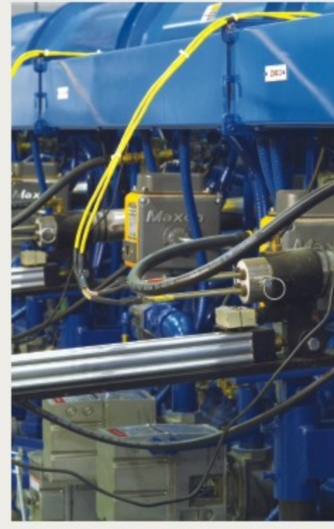
多点热电偶探针监控加热区域，确保精确、一致的温度。
