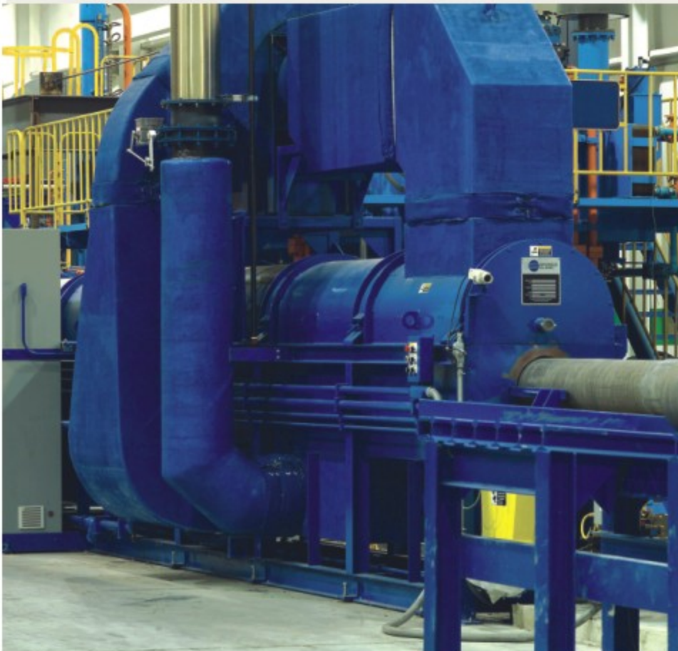
“热喷射”预热部分能提高热效率
