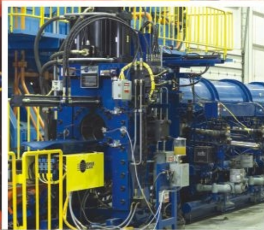
格兰克 (GRANCO CLARK) 快速热剪与热喷射加热炉联合使用，在挤压之前按要求迅速剪切柱棒，从而可极大的提高生产效益。
