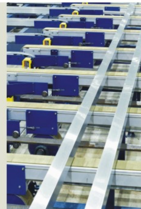
冷却台为型材冷却提供了一个干净、整洁的台面，保证型材的外观质量。
