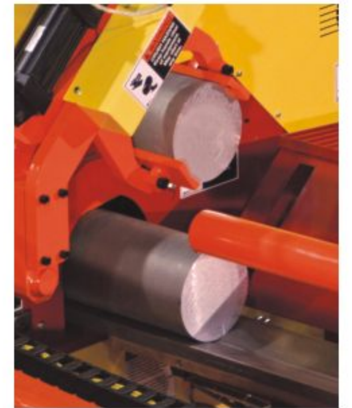
补偿切割的特性就是让锯“预先计划”，避免因太短的柱棒端头产生废料。
