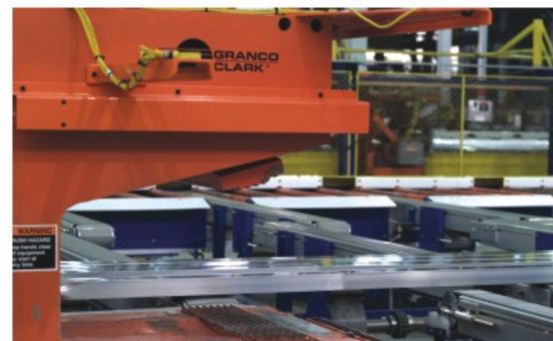
拉伸机夹钳打开接受新的型材组...
