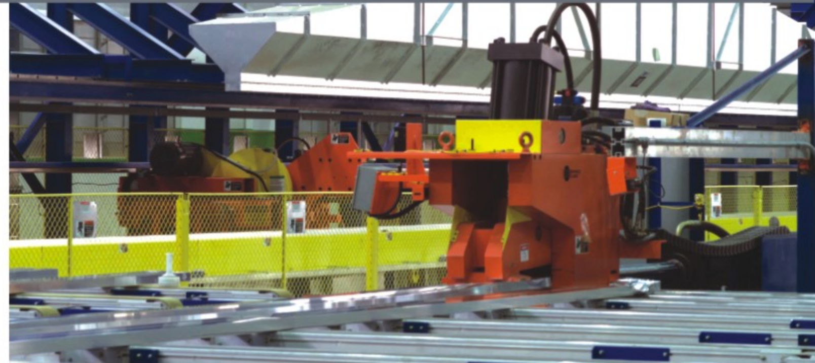
格兰克 (GRANCO CLARK) 的可控垂直夹紧拉伸机 (CVCS) 可提供最大的夹紧力，而使型材变形更小。
